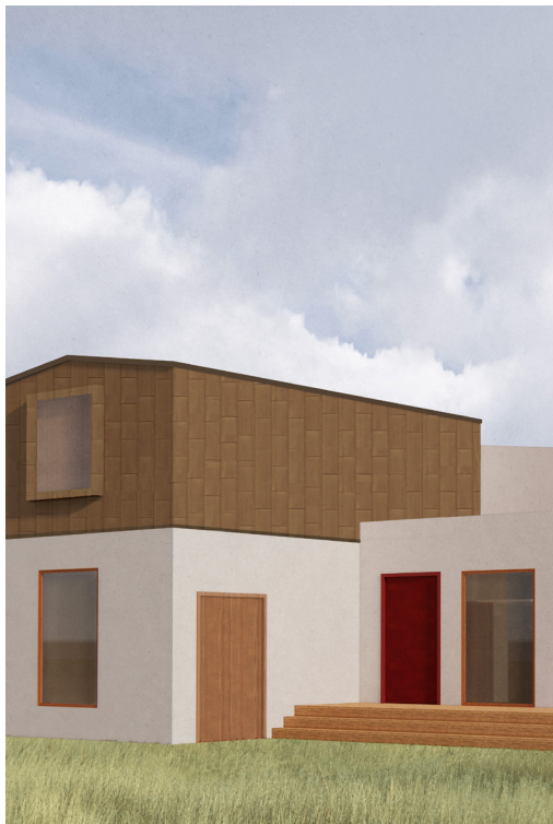
I afprøvningen af facadeudtryk har jeg arbejdet med princippet omkring opdeling af nyt og eksisterende. Skitsen har ført til valget af et mere sammenhængende udtryk, hvor der arbejdes videre på en hvid ensartet facade.
